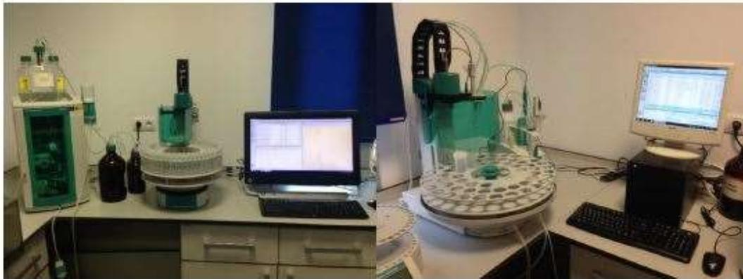
Figura 5: Cromatógrafo para el análisis de aniones (izquierda) y para la determinación de la alcalinidad total (derecha) en el laboratorio del CEHIUMA.
