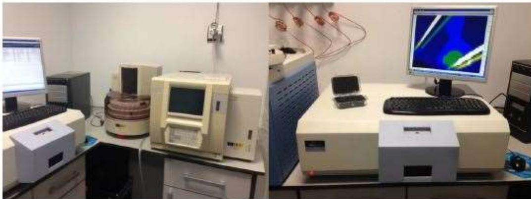
Figura 6: Equipo Shimadzu TOC-V CSN para los análisis de COT y NT (izquierda) y espectrofluorímetro PERKIN ELMER LS-55 (derecha) en el laboratorio del CEHIUMA.
