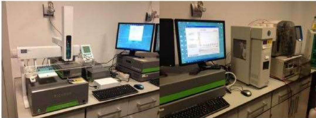
*Figura 7: Equipo PICARRO L2120i-CRS para el análisis de los isótopos de la molécula de agua (izquierda) y equipo PICARRO G1111i-CRDS para el análisis de  $^{13}\text{C}$  (derecha) en el laboratorio del CEHIUMA.*
